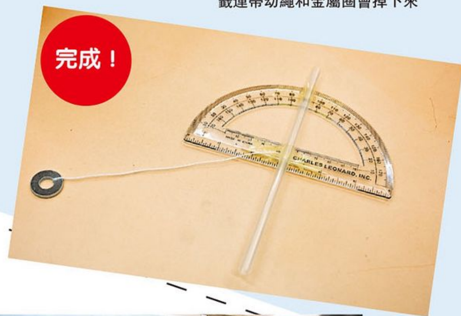
6 在貼着牙籤的膠紙上從其中一邊輕輕向橫剪一下，讓原本連同牙籤被膠紙固定的幼繩能單獨分拆出來，自由擺動 *注意：不要將整塊膠紙剪開，否則牙籤連帶幼繩和金屬圈會掉下來
