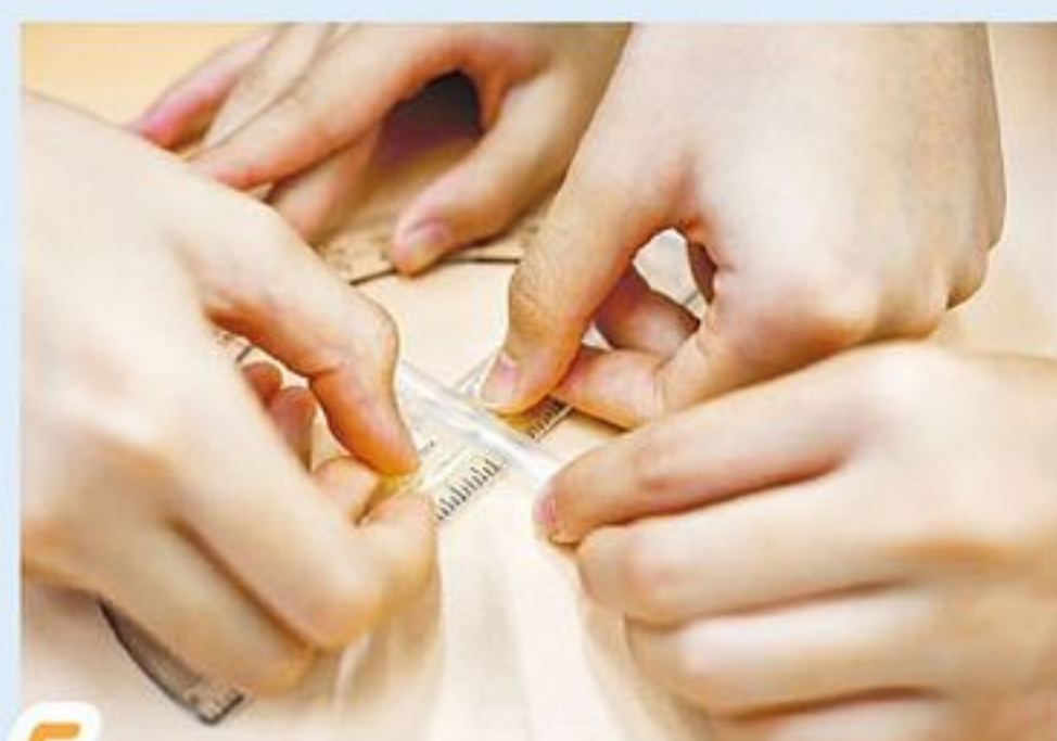
5 將粗飲管貼在半圓量角器上，底部量角器直徑位置的飲管要較頂部圓周的長
