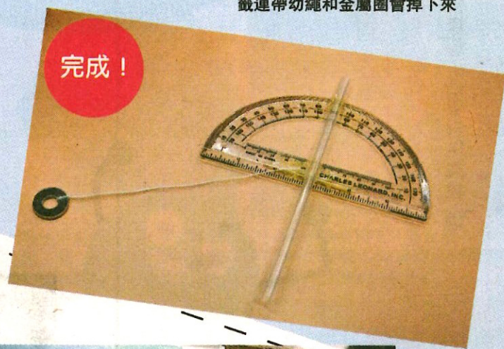
6 在貼着牙籤的膠紙上從其中一邊輕輕向橫剪一下，讓原本連同牙籤被膠紙固定的幼繩能單獨分拆出來，自由擺動 *注意：不要將整塊膠紙剪開，否則牙籤連帶幼繩和金屬圈會掉下來
